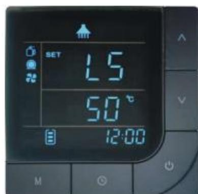
L5 er parameter for settpunkt varmtvann
