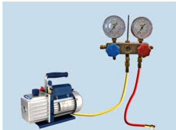
Det trengs en vakuumpumpe og en manifold-instrumentmåler/manometer.
